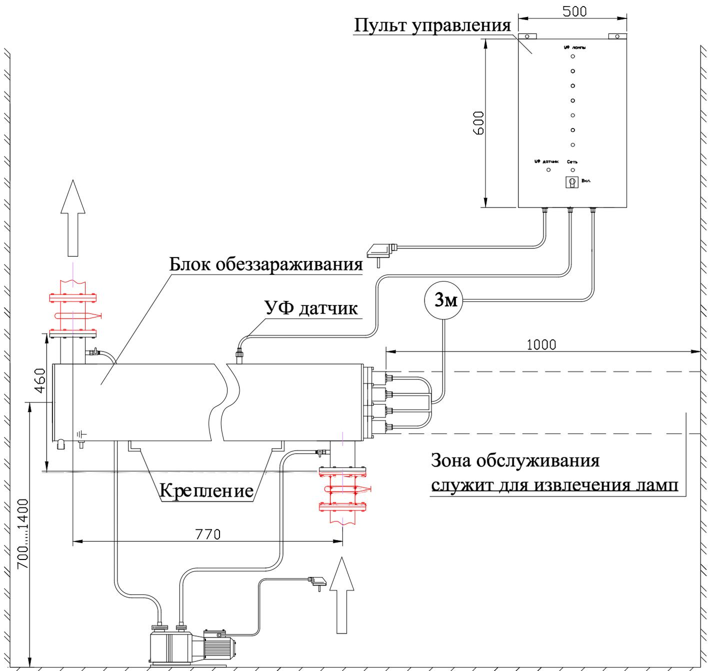
Примечание: монтаж установки к стене или полу производится при помощи крепежных уголков находящихся на блоке обеззараживания
